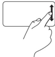
Déplacez un doigt vers le haut ou le bas dans la zone de défilement vertical (partie la plus à droite du pavé tactile).
