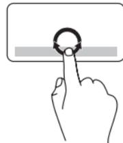
Dessinez un cercle dans la zone de défilement horizontal (partie inférieure du pavé tactile) avec votre doigt, dans le sens des aiguilles d'une montre pour un défilement vers la droite, dans le sens inverse pour un défilement vers la gauche.
